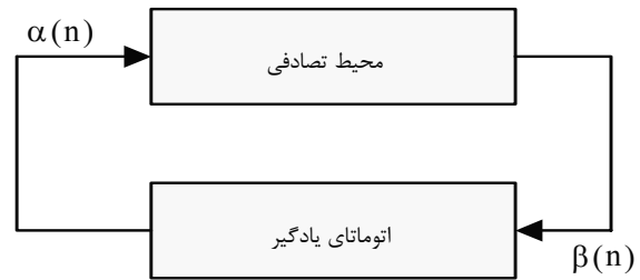
شکل ۱: ارتباط اتوماتا با محیط
